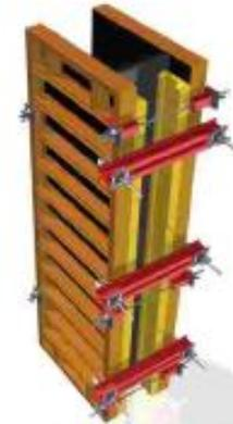
nel caso in cui superano i 75 cm quindi a partire da 1 m è necessario utilizzare insieme agli allineatori anche gli attacchi tirante esterno (per altezze di 3 m si usano 3 allineatori e 3 attacchi tirante esterno)
